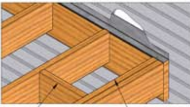
BLOQUE VIGA DE APOYO
